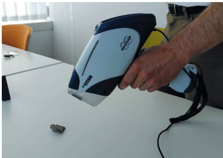
Pistolet laser pour analyser la teneur en brome des fractions de plastique
