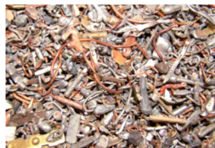
Fractions métalliques issues du recyclage des DEEE.
